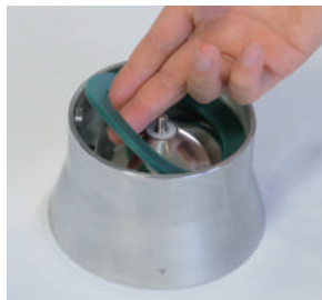
ウレタンマットの取り外し
